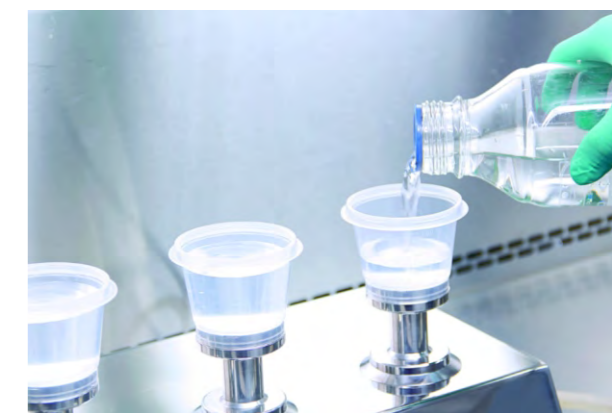
2 安装滤杯，添加样品并过滤
